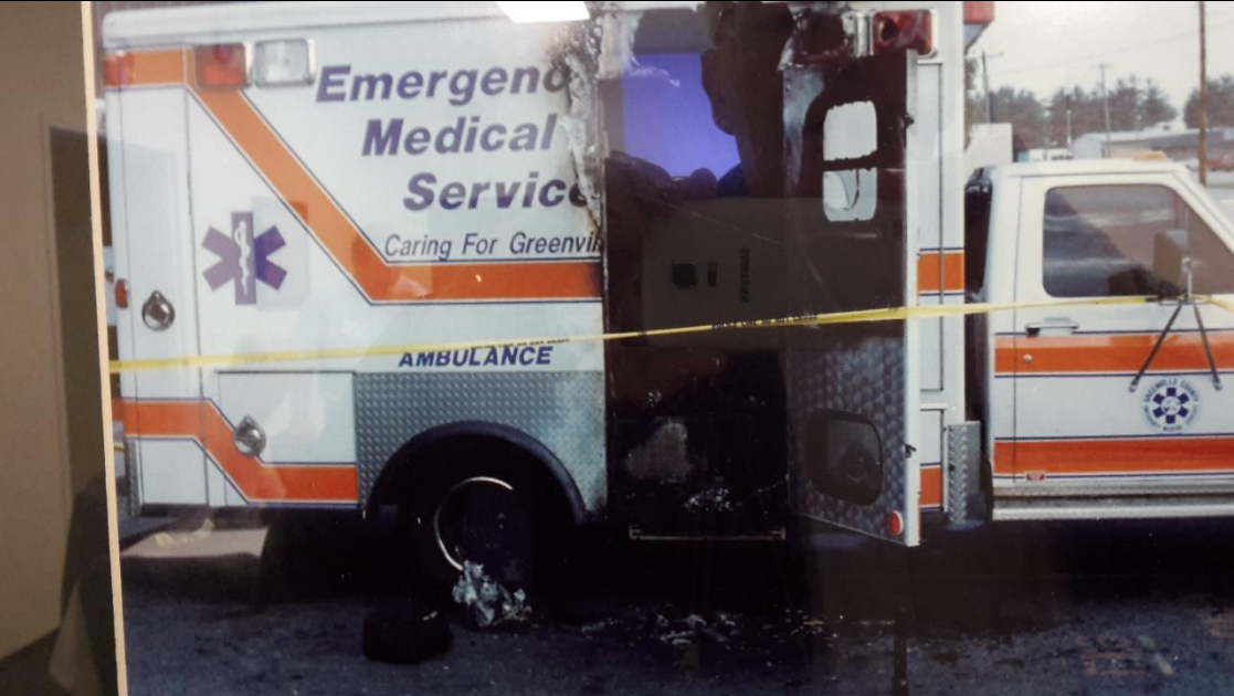
Photos de photos (désolé pour la qualité) : ce qui reste d'une ambulance après un feu d'oxygène.
