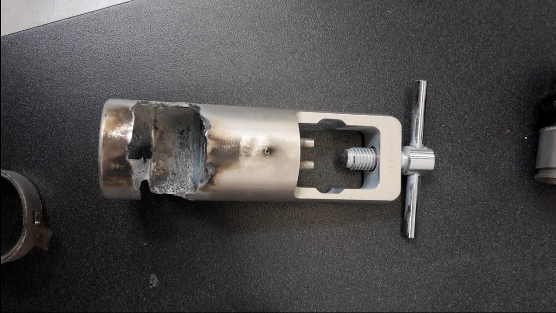
Feu sur les structures de têtes de bouteilles; en bas à droite, observer les dommages sur le masque O2
