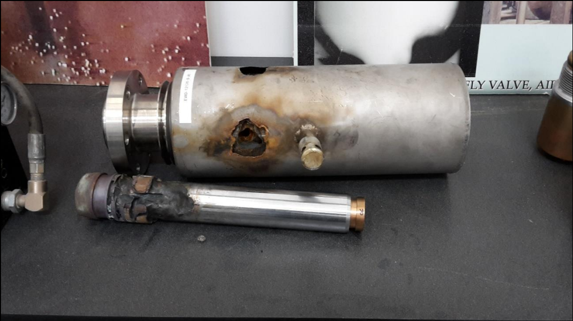
Feu sur les structures de têtes de bouteilles; en bas à droite, observer les dommages sur le masque O2
