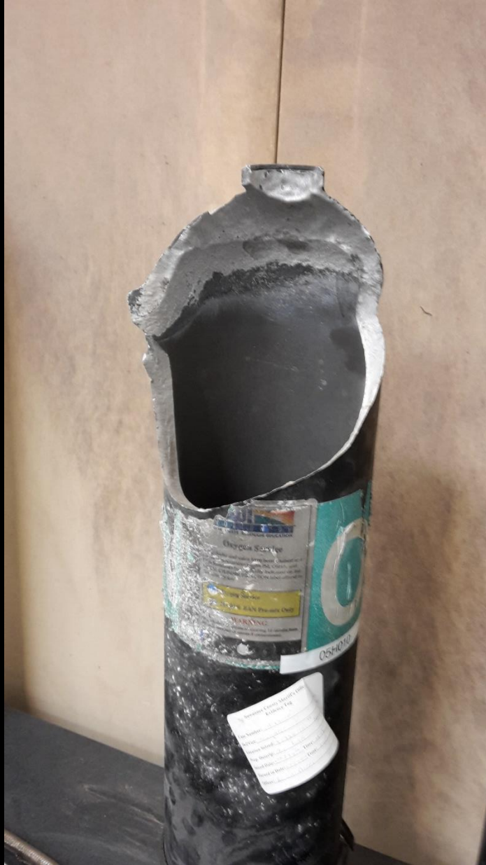
Feu initié dans la bouteille à haute pression puis éclatement du fût
